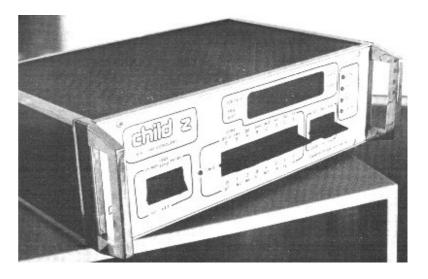
Il pannello di controllo e' un piccolo capolavoro – lavora ad interruzione con un monitor in ROM – permette di eseguire step sulle istruzioni - visualizza i registri dello Z80 in esadecimale sui LED – permette una semplice introduzione del programma direttamente in esadecimale.
